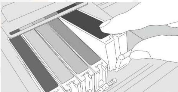
プリンターから洗浄カートリッジを使用するカラーのインクを外してください。
