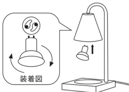
①付属の電球をソケットの穴の位置に合わせて差し込み、半時計回りに回して取り付けてください。電球が2個付属している場合は、残りの1個は予備です。電球が切れた際に交換してご使用ください。
