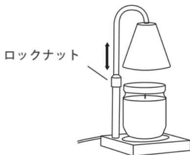
③高さ調整機能付きの製品の場合は、ロックナットを緩めてキャンドルの高さに合わせて調整できます。この時、キャンドルから2cm以上離れた位置に固定してください。
