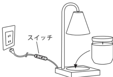
②電源コードをコンセントに差し込みます。キャンドルを台座の中心に置きます。スイッチで電源を入れ、ランプを点灯させます。スイッチの詳細な使用方法は次ページをご確認ください。
