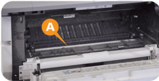
★ローラーを清掃することで、カートリッジ内への紙粉混入を防ぎ、印字汚れの防止となりますので必ず行なって下さい。
