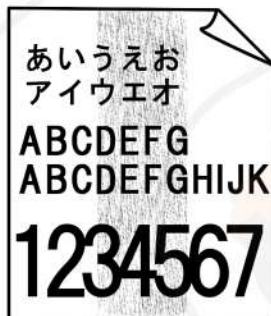
汚れが生じる
